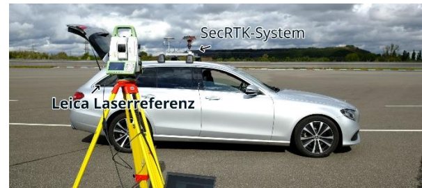
GNSS-unabhängiges Referenzsystem mit Leica MultiStation
